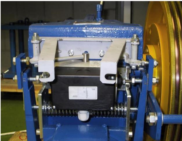
Abb. 6: Kipphebelsystem zum getrennten mechanischen Öffnen der Bremshebel
