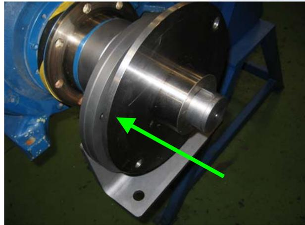
4. Montagehilfsmittel und Flanschplatte mit 2 Schrauben (M12x20) zusammenfügen und bis zum Anschlag auf die Welle aufschieben
