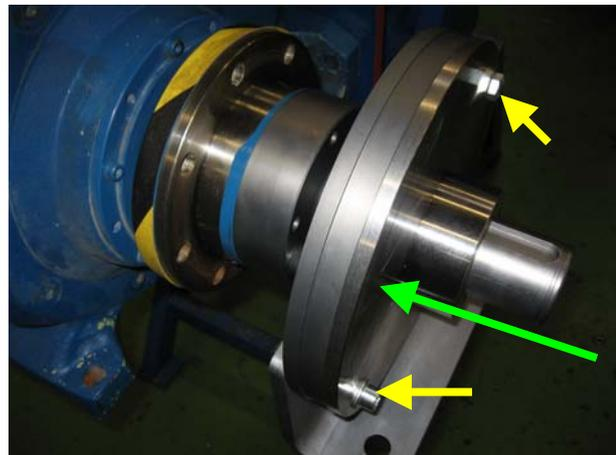
5. Den Gegenhalter am Maschinenrahmen ausrichten, evtl. mit Ausgleichsblechen unterlegen und festziehen.
